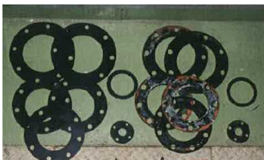
内部配管パッキン新旧（1系統分）
