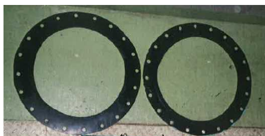
マンホールパッキン新旧（1系統分）
