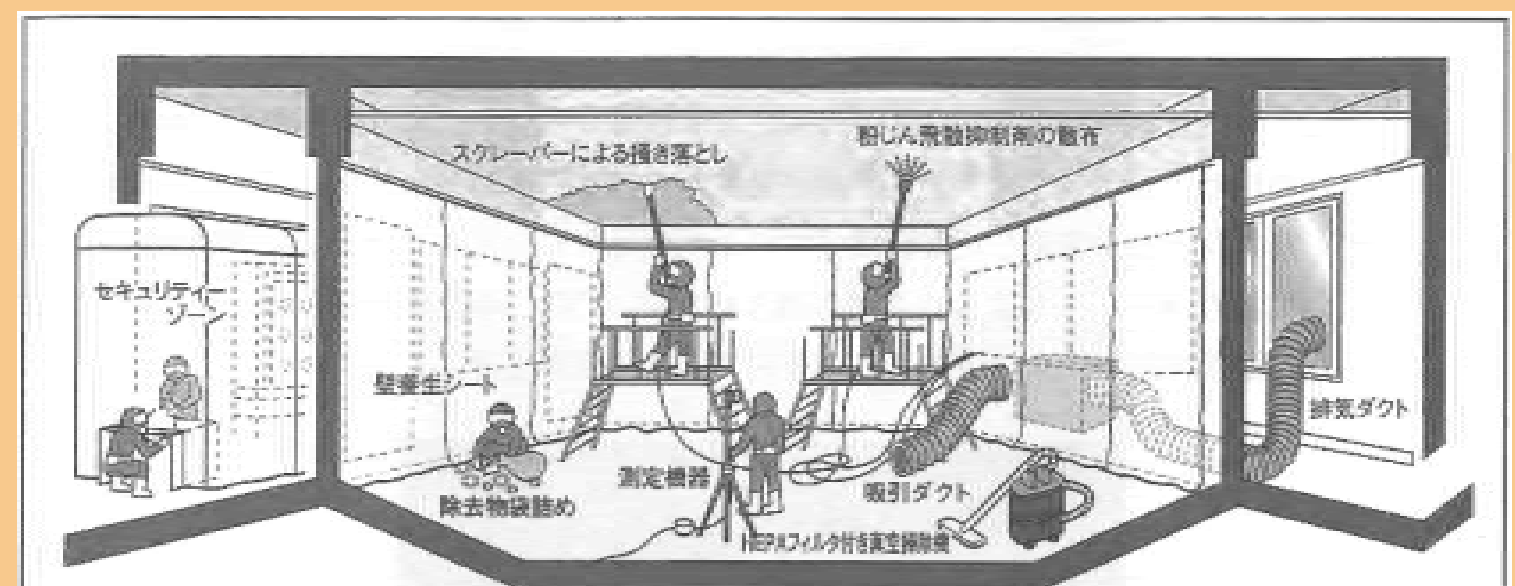
石綿含有吹付け材除去作業概念図
