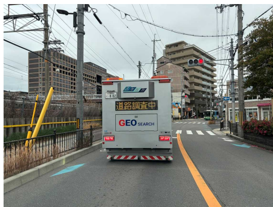
路面空洞調査
