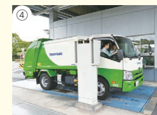
④ エネルギーセンターで重量を計測。将来のごみの量の予測やエネルギーセンターの運転計画に役立ちます
