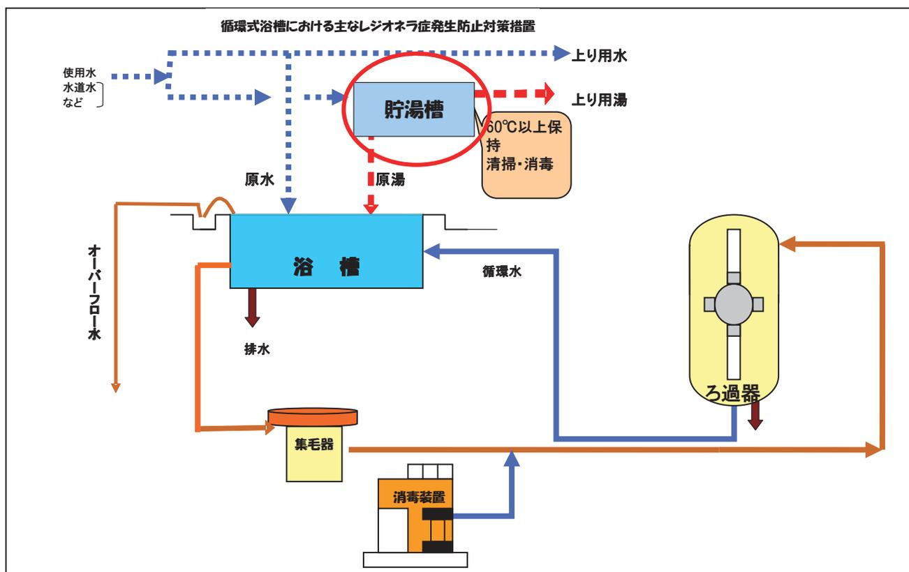
(3) 浴槽から排出された水を再利用するための回収槽を設置する場合は、入浴によって生じた汚れを多く含んだ水を貯留しているため、壁面等に生物膜が定着しやすく、レジオネラ属菌が繁殖しやすい状況にあることから、回収槽の水を浴用に使用しないこと。
