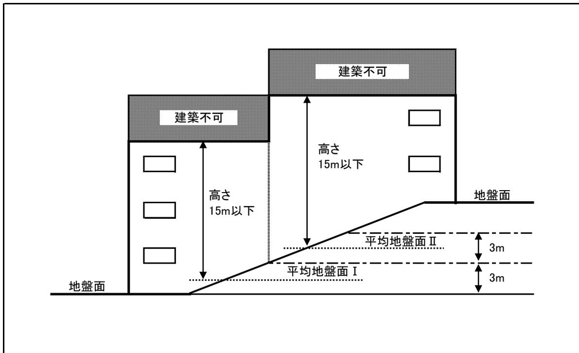
図一 2 (外壁後退の壁面とみなさないことができるバルコニー (ベランダの類を含む) の形態)
