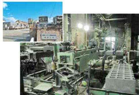
また、高槻工場では、業界最高クラスの強度を誇る建築用コンクリートブロックを生産しており、小田原城天守閣の耐震補強にも使用されました。自社製品を用いた施工も行い、施設を使用しながら無騒音・無振動で耐震補強の施工ができる「居ながら工法」が脚光を浴びています。既成概念を超えて、従来には無い新たなデザインや機能を備えたコンクリートブロックを開発するとともに、発電事業にも着手する同社。従来のコンクリートブロックのイメージにはない新たな付加価値を持たせることで、社会に貢献する企業です。(産業振興課)
