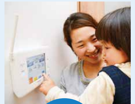
太陽光発電システム 室内のモニターをチェック。屋根に取り付けたパネルがどれだけ発電しているかが分かる
