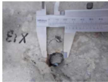
写真 3. 接合筋が引き抜けた跡 (コンクリートの表面剥離)
