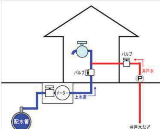
上の図のように水道の給水管と、井戸水など水道以外の管が直接連結されている状態をクロスコネクションといいます。バルブや逆流防止装置を設置し、必要に応じて水道水と井戸水などを切替えて使用されている状態もクロスコネクションになります。
