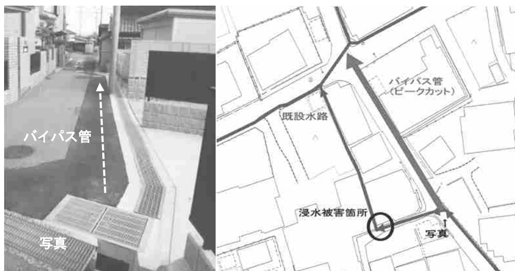
局所的浸水対策工事を実施
